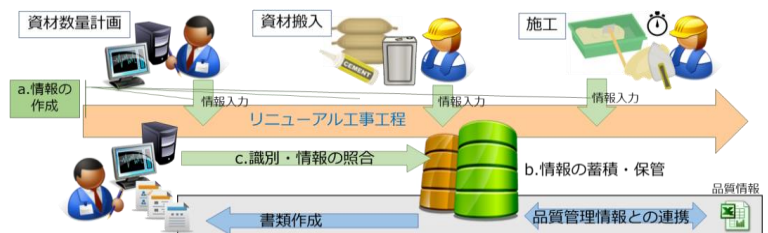
図4 補修材料のトレーサビリティシステム概要
